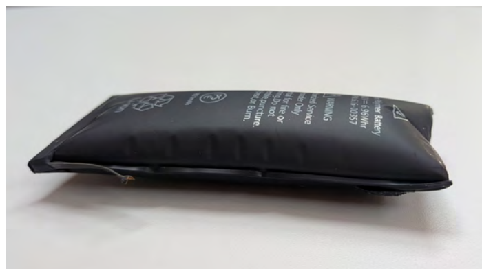
Durch längere Lagerung können Akkus kaputt werden. Aufgeblähte Akkus müssen dringend zum Wertstoffzentrum gebracht werden – hier herrscht akute Brandgefahr.
