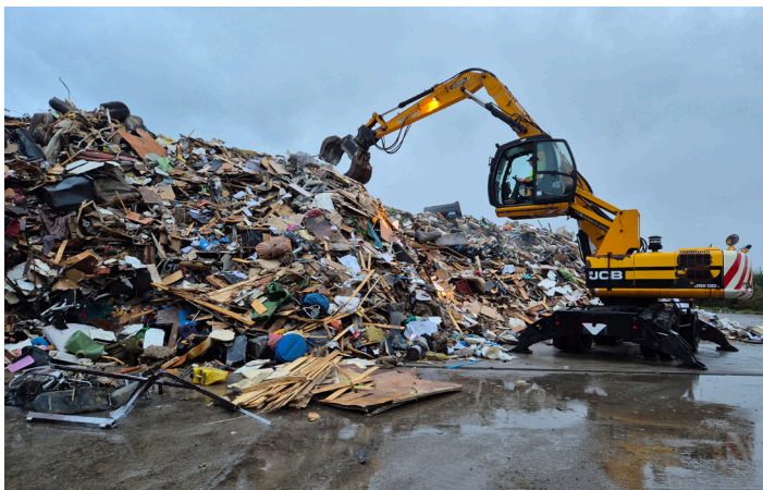
Mit dem Sortierbagger wurde versucht den Abfall nachträglich zu trennen
